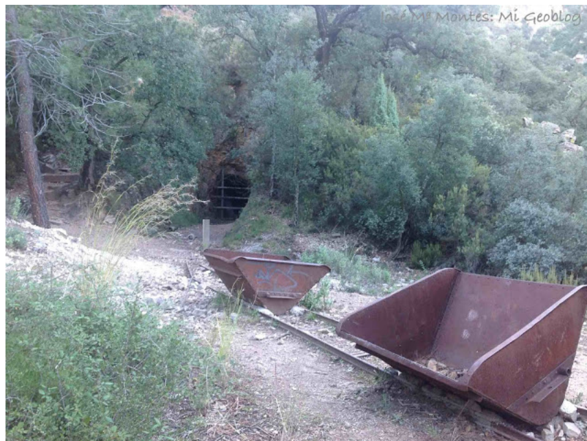
Figura nº 14: Vagonetas de volcado lateral cerca de la bocamina y de la escombrera de El Socavón.
