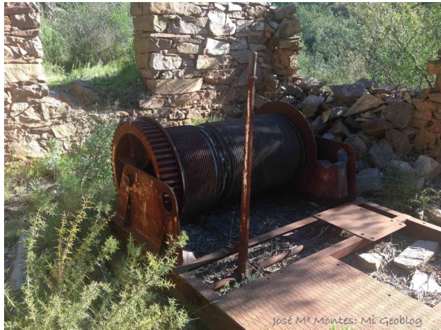
Figura nº 18: Cabrestante con torno y cable que servia para subir y bajar la jaula al pozo.
