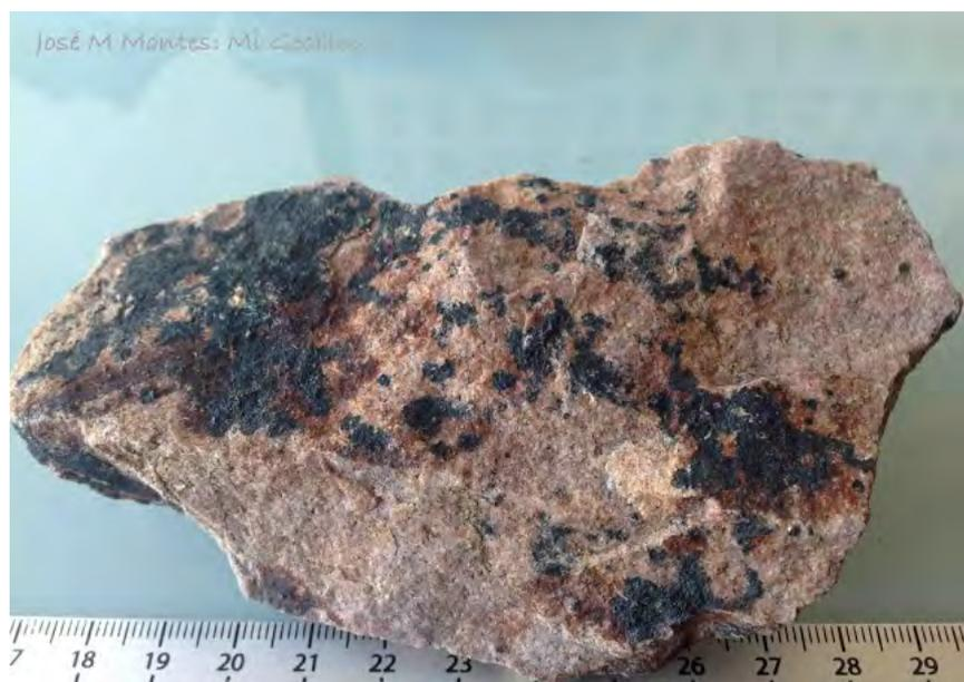
**Figura nº 67:** Impregnación de asbolana en una muestra de mano de una cuarcita de la Formación Cañizar.
