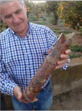
Testigo de un sondeo geotecnico
