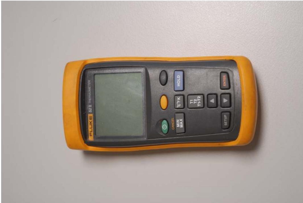
Fig 2. Equipo FLUKE 52II para medida de temperaturas.
