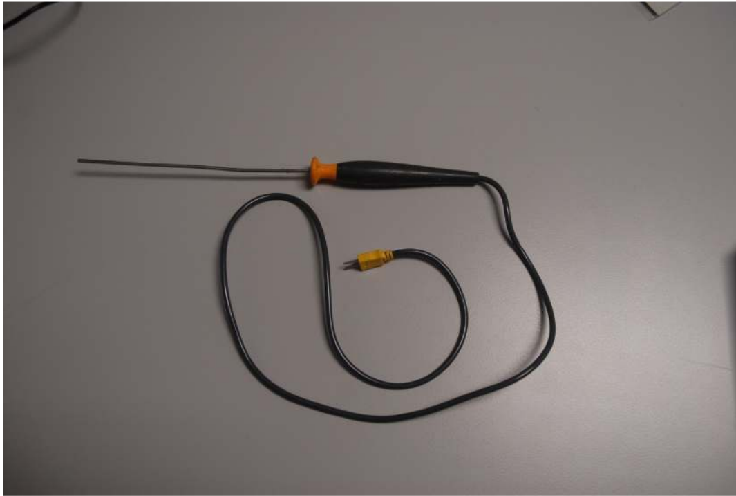
Fig 3. Sonda de temperatura FLUKE, termopar de tipo K en sonda de inmersión
