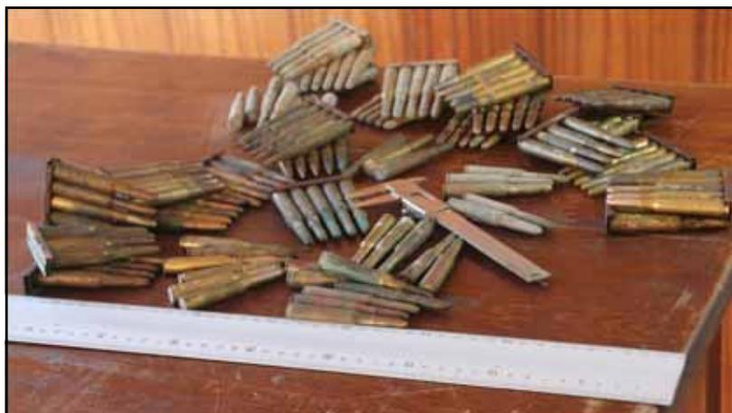
Figura 3: Cartuchos de munición de guerra 7 X 57 y 7 X 52, en proceso de limpieza para su identificación.
