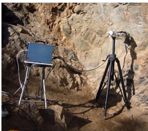
Figura 1: Espectrómetro EDXRF portátil. (Foto de os autores)
