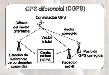
El receptor de referencia calcula la distancia entre la posición de cada satélite (información transmitida por los propios satélites) y la posición del propio receptor de referencia (situado en un punto de coordenadas conocidas). Comparando la distancia calculada con las pseudo distancias observadas, el receptor de referencia puede calcular una corrección de la pseudo distancia para cada satélite, así como también la velocidad de cambio de dicha corrección.
