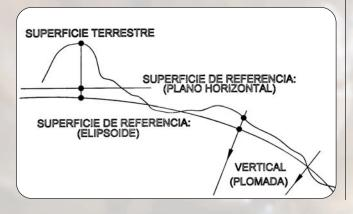
Debido a la imposibilidad de definir la superficie real de la tierra por una expresión matemática, el problema se ha afrontado clásicamente adoptando diferentes superficies de aproximación, la esfera, el elipsoide de revolución, el elipsoide de tres ejes, el geoide (éste por razones físicas) etc.
