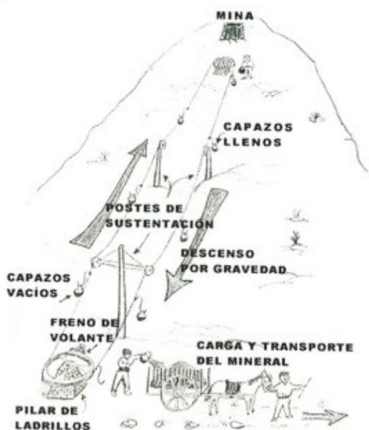
Sistema de transporte volante empleado en las minas para el descenso del material hasta los lugares accesibles a las caballerías.
