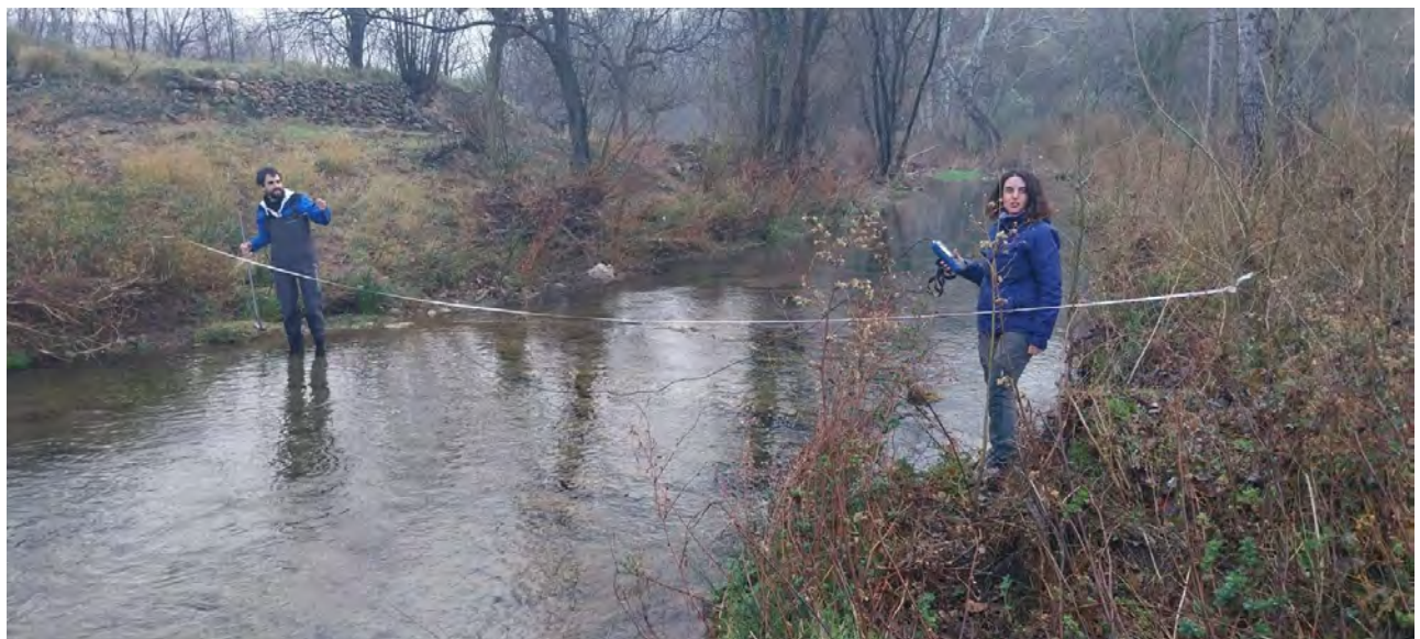
Figura 40: Medida directa del caudal en el río Palancia a su paso por Bejis.
