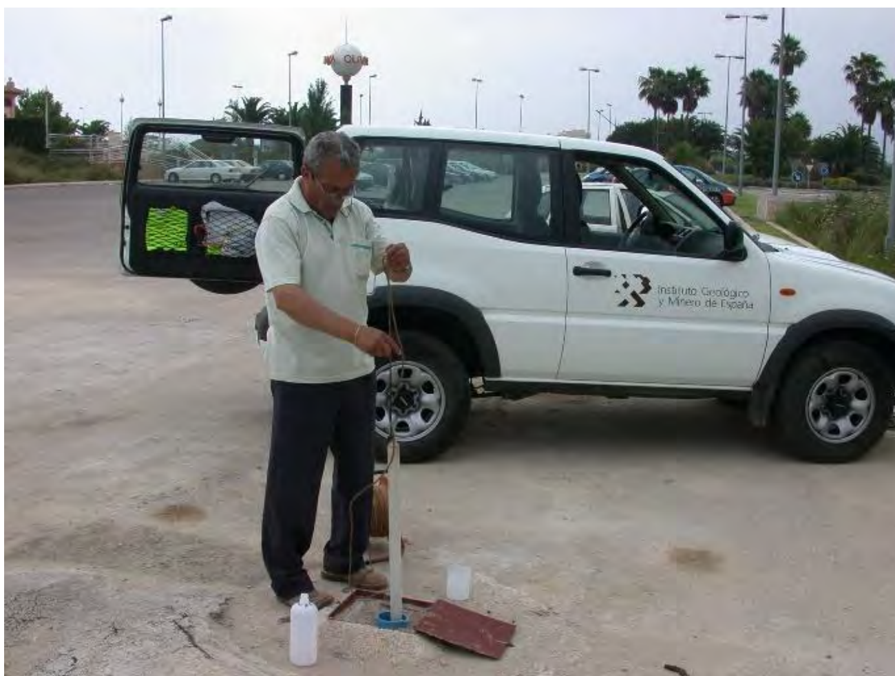
Figura 30: Toma de una muestra de agua subterránea en un piezómetro mediante tomamuestras
