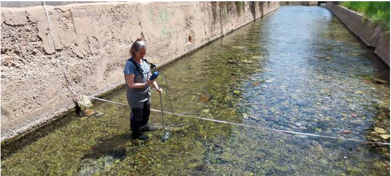
Figura 39: Medida directa del caudal en la Séquia de l'Obra del Molí de la Font.
