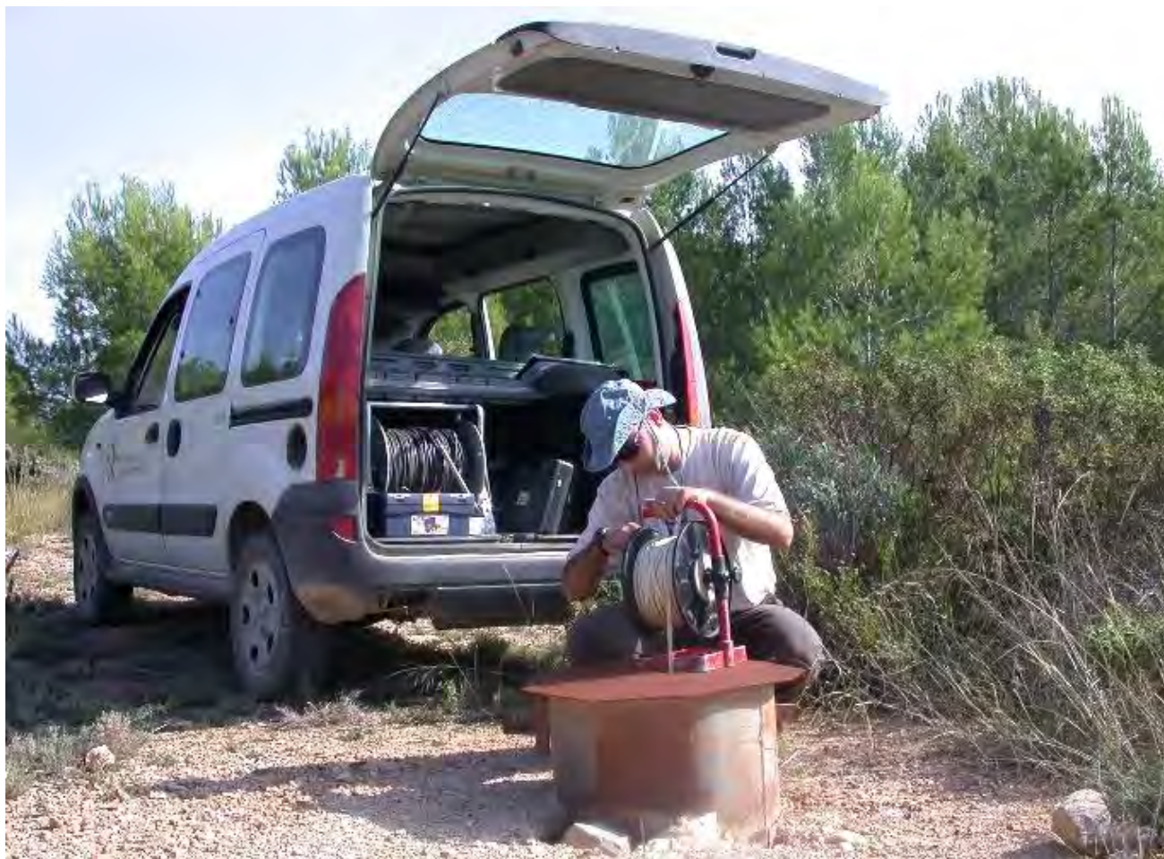
Figura 36: Medida del nivel piezométrico mediante sonda.
