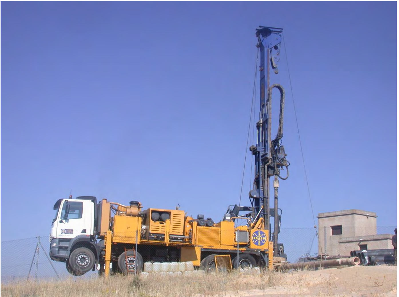
Figura 17: Perforación de un sondeo a rotopercusión
