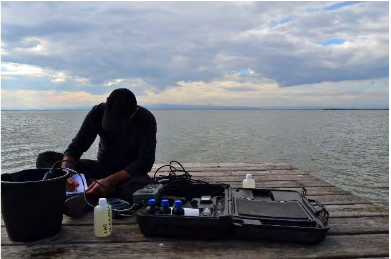
Figura 31: Toma de muestra de agua en L'Albufera de Valencia (embarcadero de la "Gola de Pujol") y medida de parámetros "in situ" (temperatura, pH y C.E.)
