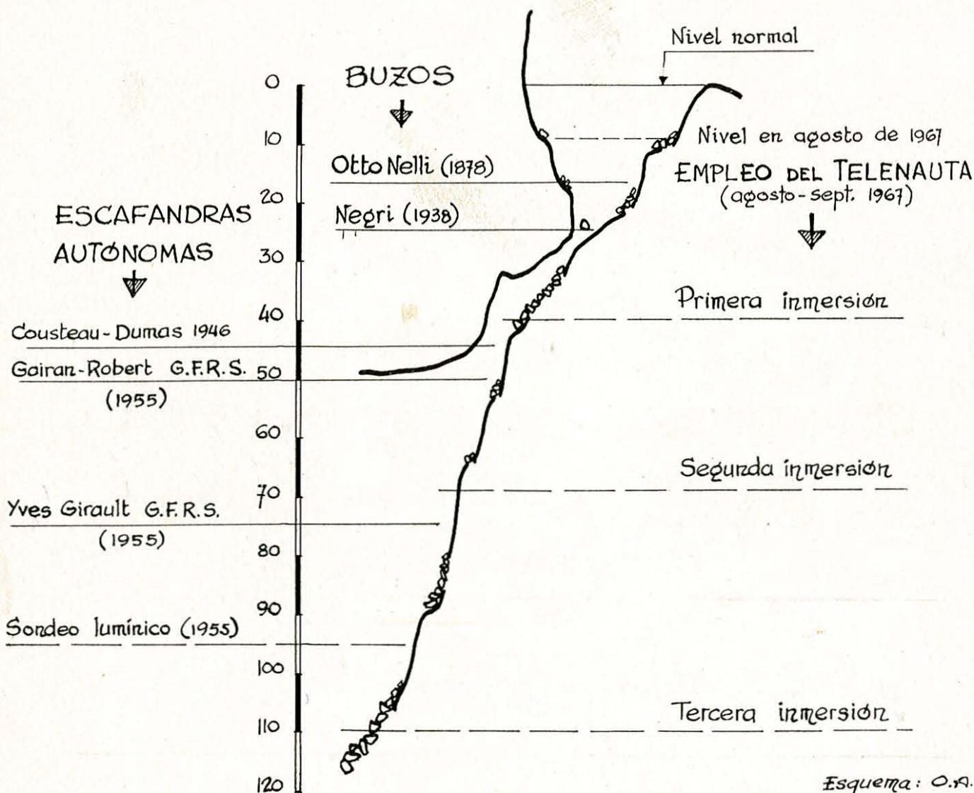
**El robot submarino "Telenauta" alcanza por vez primera los 110 metros de profundidad vertical, aguas adentro del pozo.**
